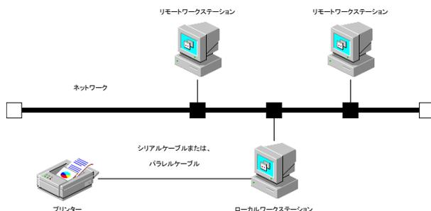
下図は、プリンタにインターフェースボードを装着して直接ネットワークに接続した場合の例です。
