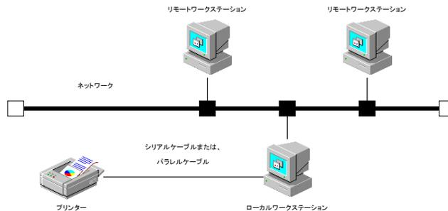
下図は、プリンタにインターフェースボードを装着して直接ネットワークに接続した場合の例です。
